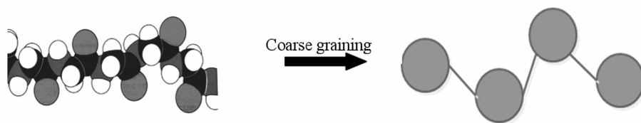
图 3 目标流体经过粗粒化的过程成为 DPD 粒子模型
